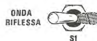
Fig. 6 Dopo aver eseguito l'operazione descritta in fig. 5, senza più muovere il potenziometro della sensibilità, si sposterà il deviatore in posizione ONDA RIFLESSA e subito la lancetta dello strumento si sposterà verso sinistra. Controllate la posizione nella quale questa si è fermata e con l'aiuto della TABELLA N. 1 conoscerete il rapporto SWR o il rendimento della vostra antenna.
