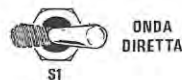
Fig. 5 Utilizzare un misuratore di onde stazionarie è molto semplice. Dopo averlo collegato in serie tra il trasmettitore e il cavo coassiale dell'antenna, si porterà il deviatore S1 in posizione ONDA DIRETTA e si ruoterà il potenziometro della sensibilità fino a portare la lancetta dello strumento sul fondo scala.
